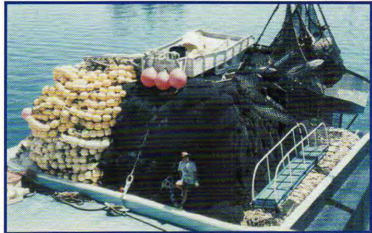
Senne tournante coulissante stockée sur le pont du senneur
